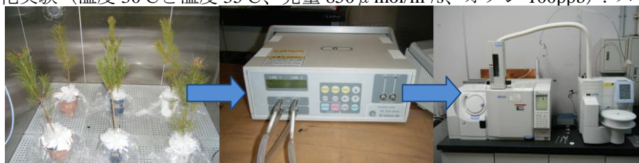
グローブチャンバー サンプリングポンプ 捕集管 GC/MS ATD
