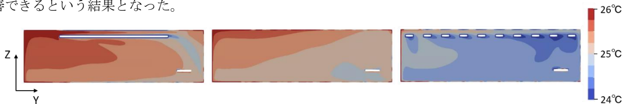
図 4 単一パネル型 (左)、マルチパネル型 (中央)、スリットパネル型 (右) の温度分布 ( x=3.0\text{m} )
