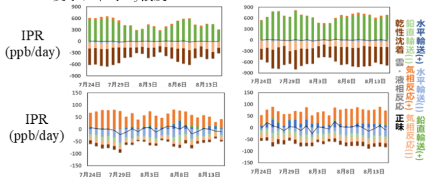
図 3 2012 年 (左) と 2013 年 (右) の関西における地上 (上段) と 1 km 内 (下段) の IPR 解析結果
