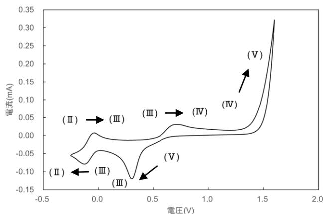
図1 希硝酸溶液中のバナジウムのサイクリックボルタモグラム
